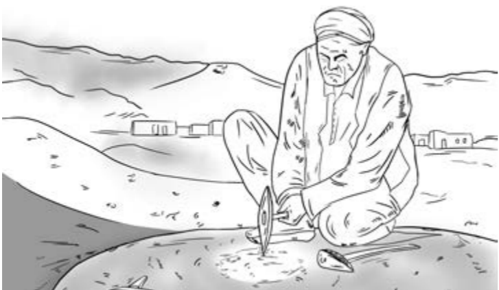
تصویر۱: استاد سنگتراش که به وسیله ابزار آجینه، محل گودی سنگ را آماده می‌کند، ترسیم: عماد زارعی
