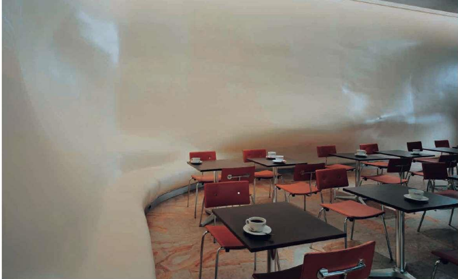
کف: کاشیهای سنگی کلمبیایی مالک سقف: صفحه‌ی گچی رنگ‌شده
