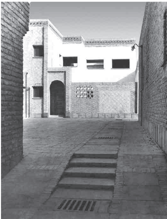
نموداری از طراحی کف سازی معابر پیاده (قبل از تحویل) با در نظر گرفتن رامپ‌هایی برای حمل وسایل چرخ‌دار و عبور اشخاص معلول. تأسیسات زیر بنایی شهر در وسط کوچه در زیر زمین پیش-بینی شده، ضمن اینکه برای عبور آب‌های سطحی نیز پیش‌بینی‌های لازم صورت گرفته است.
