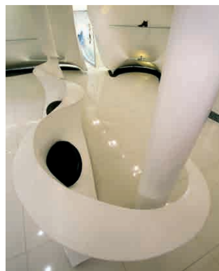
نماهای مختلفی از دیواره‌ها، میز و مبلمان که با استفاده از تکنیکهای برش مقاطع و قالبگیری فایبرگلاس و در بعضی نقاط با استفاده از روکش بال گلایدر طراحی و اجرا گردیده.
