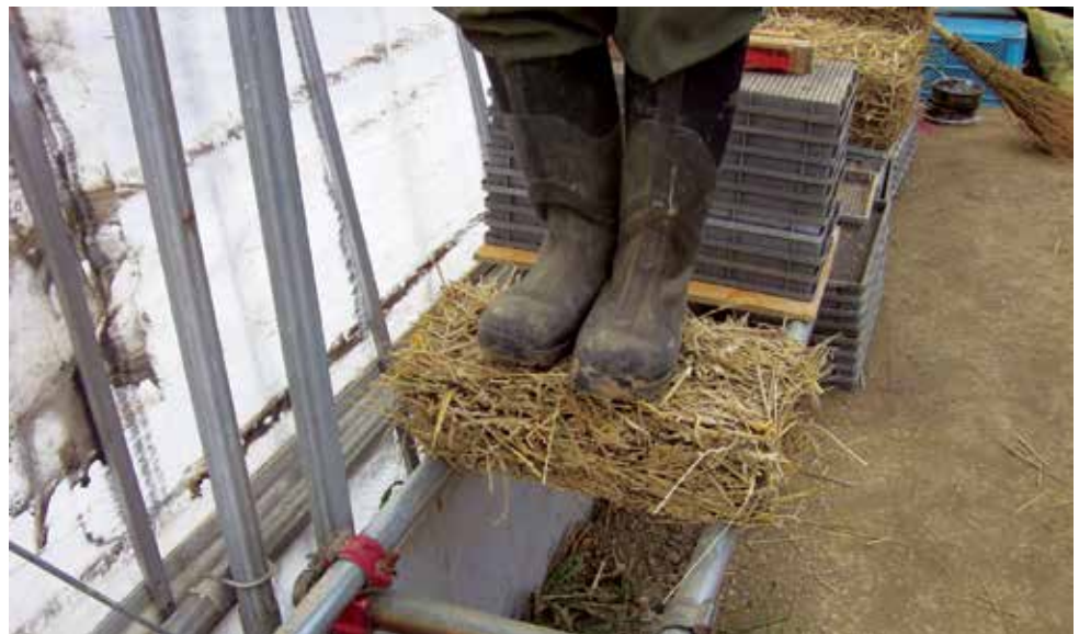
تصویر ۱۷. بازرسی مقاومت بلوک برش خورده [Retrieved September 8, 2016. From http://holzhueter.blogspot.com/200911/straw-clay-block-test-wall.html ]
