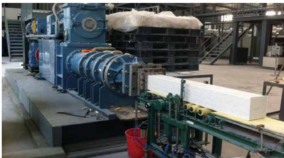
تصویر ۱۴. ساخت آجر با تکنیک خاک قالبی به صورت ماشینی
