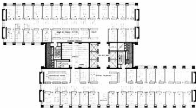
نقشه‌ی پلان ساختمان مک میلن بلودل نشان‌گر آزادسازی فضا از وجود ستون در میان می‌باشد و تمامی بار بنا از طریق دیوارهای باربر ضخیم، به پی منتقل می‌شود.
