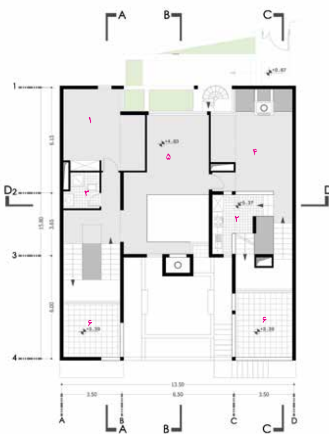
پلان طبقه اول ۱. اتاق خواب اصلی ۲. آشپزخانه ۳. سرویس بهداشتی ۴. اتاق نشیمن ۵. کتابخانه ۶. تراس
